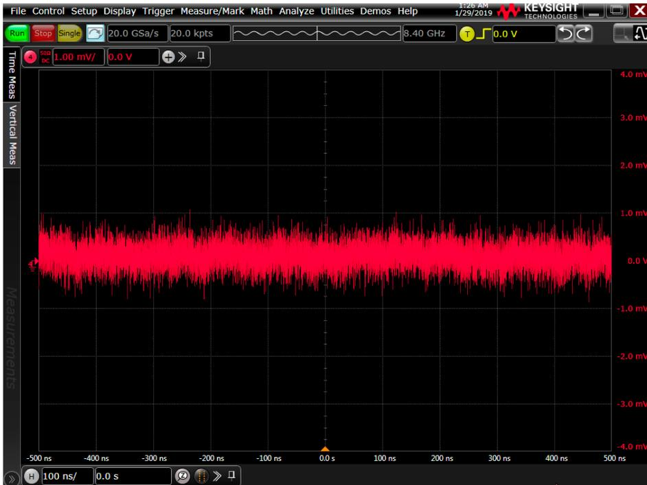
그림 4. S-시리즈가 1 mV/div 및 1 GHz 대역폭에서 유발하는 노이즈는 90 uV에 불과합니다.
