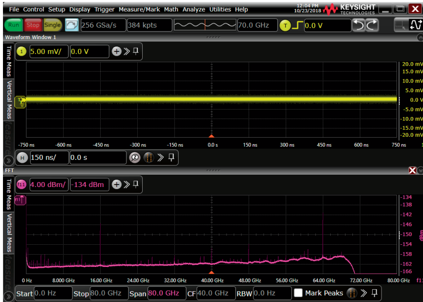
그림 7: 키사이트 UXR-시리즈 오실로스코프 노이즈 밀도 플롯, 10비트 ADC, 주파수 인터리빙 없음
