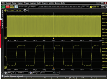
강력한 신호 캡처 1 Gpts 메모리를 사용하여 40 GSa/s일 때 PCI Express Gen2 데이터 25 ms를 수집해서 관심 신호를 캡처하십시오.
