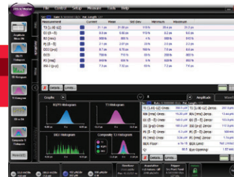
고급 지터 및 진폭 분석 지터 및 진폭 손상에 대한 정확한 분해는 토탈 지터 (TJ) 결과와 eye 클로저의 근본 원인에 대한 통찰력을 제공합니다.
