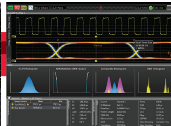
딥 메모리 딥 메모리로 낮은 주파수 지터 성분을 보여줍니다.
