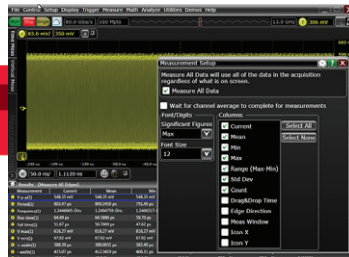
“모든 에지 측정” 모드 “모든 에지 측정” 모드와 긴 메모리를 사용해서 1분 이내에 5백만 회 이상 측정하여 측정 통계에 대한 확신을 높이십시오.
