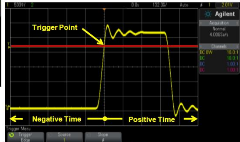
Trigger = Rising edge @ +2.01 V
