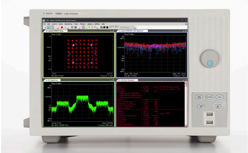
그림 4. 로직 분석기에서 실행되는 애질런트의 89600 벡터 신호 분석 소프트웨어를 이용해서 디지털 베이스밴드와 IF 신호에 대해 심층적인 시간, 주파수, 변조 도메인 분석을 수행합니다.
