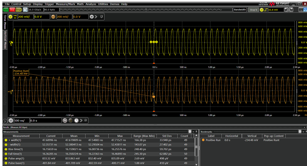
그림 6. View 버튼을 클릭하면 Fault Hunter가 발견된 오류로 이동합니다.
